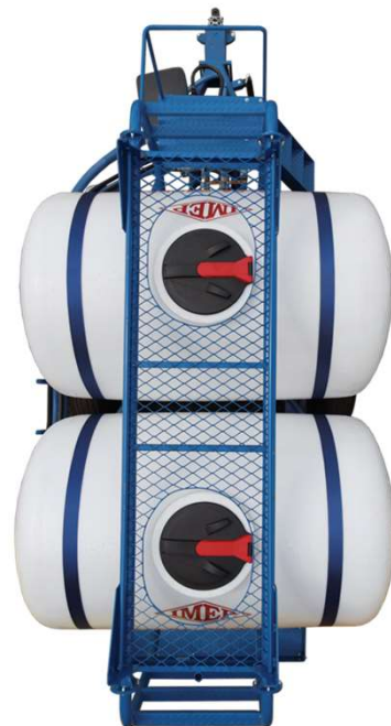
Vista aérea da carreta calda pronta 2 reservatórios
